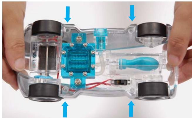
Sostenga el chasis ensamblado en su mano y voltéelo para encontrar 4 pequeños orificios cerca de las orillas del chasis y cerca de las 4 ruedas. Debe alinear los orificios del chasis con los orificios de la carrocería del auto (figura 7C).
