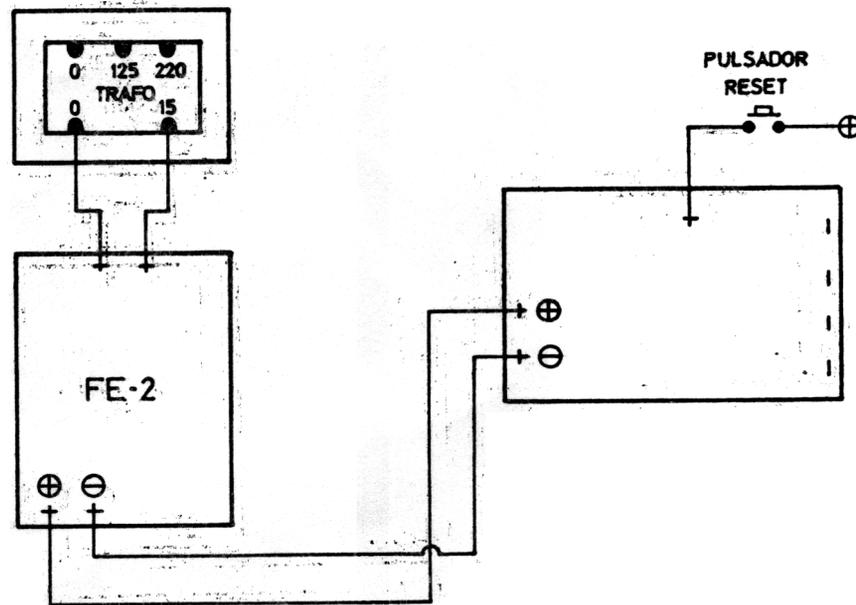
**IMPORTANTE .** La alimentación del circuito debe estar perfectamente estabilizada y filtrada para obtener una correcta estabilidad.
