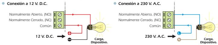
**CONSIDERACIONES sobre el RELE.** Especialmente con cargas inductivas, una salida a relé puede producir una fluctuación, rateo, o un incorrecto funcionamiento. Si esto ocurre, instale un circuito anti-chispas entre los dos contactos del relé utilizados en la conexión, que asegurará la absorción del pico de corriente que origina el citado problema.
