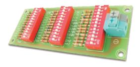
La "Caja de Resistencias" es una herramienta compacta y altamente útil, de uso muy extendido en laboratorios de ensavo y diseño, donde a menudo deben probarse distintos valores, sin que para ello sean necesarias redundantes operaciones de soldadura y desoldadura.
