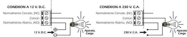
**CONSIDERACIONES SOBRE LA SALIDA.** Durante el funcionamiento del circuito, y especialmente con cargas inductivas, podrá producirse una fluctuación o un incorrecto funcionamiento de la salida. Si esto ocurre, instale un circuito anti-chispas entre los dos contactos del relé utilizados en la conexión.
