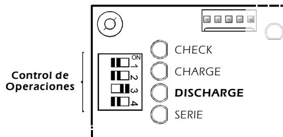
Observe la siguiente fig. El módulo, además de la placa base de Control, donde encontrará la tecla Enter, incluye otra placa con 4 preselectores, uno por cada cifra, (unidades, decenas, centenas y unidades de millar). Mediante estos preselectores y la tecla Enter se realizará la operación de baja.
