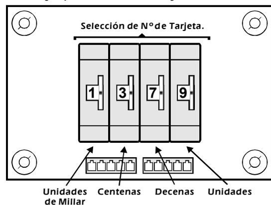
**Verificación o Chequeo de la situación de las tarjetas.** Es muy probable, que con el tiempo, con un funcionamiento continuo del DA-02 en el que se alternen las altas y bajas de tarjetas, pierda la noción de cual de ellas están en una situación u otra. Por ello, el módulo incorpora la función Verificación. Mediante esta opción, podrá comprobar, sin necesidad de poseer la tarjeta, si esta se encuentra dada de alta o baja.
