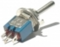
Conmutador miniatura unipolar C4081 Dimensiones: 8x5mm. Ø agujero chasis 5mm. Altura: 28mm. 3A 125VAC ...más
