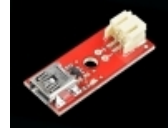
Cargador Baterías Ion Litio (LiPo) Mini USB Sparkfun SPRK-LIPOBCH
