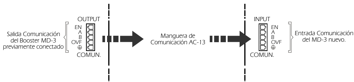
Fig. 3. Comunicación entre MD-3 previamente conectado y MD-3 nuevo.
