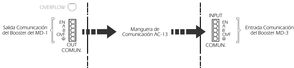
Fig. 2. Comunicación entre MD-1 y Booster esclavo MD-3.
