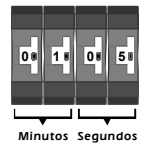
Fig. 3. Ejemplo de selección de 1' 05" como Alarma de Preselección. (Vista Frontal)
