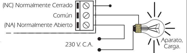
**CONSIDERACIONES SOBRE LA SALIDA.** Durante el funcionamiento del circuito, y según sea su carga, podrá producirse una fluctuación o un incorrecto funcionamiento de la salida. Si esto ocurre, instale un circuito antichispas entre los dos contactos del relé utilizados en la conexión, tal y como se muestra en el dibujo.
