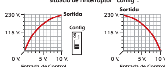
Fig. 2. Sortida en funció de Senyal de Control i situació de l'interuptor "Config".
