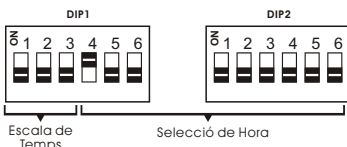
Fig. 2. Funció dels Switchs.
