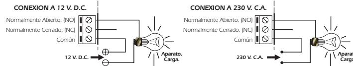
**CONSIDERACIONES SOBRE LA SALIDA.** Durante el funcionamiento del circuito, y especialmente con cargas inductivas, podrá producirse una fluctuación o un incorrecto funcionamiento de la salida. Si esto ocurre, instale un circuito anti-chispas entre los dos contactos del relé utilizados en la conexión.
