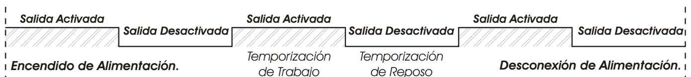
conectará la salida durante el tiempo de trabajo previamente ajustado, encendiendo el Led mientras transcurra. Cuando finalice dicha temporización, el led y la salida se desconectarán y permanecerán en ese estado durante el tiempo de reposo que se haya seleccionado, trascurrido el cual volverá a iniciarse el ciclo.
