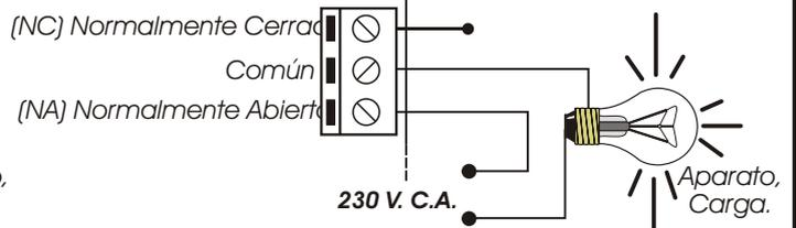
**CONSIDERACIONES SOBRE LA SALIDA.** Durante el funcionamiento del circuito, y según sea su carga, podrá una fluctuación o un incorrecto funcionamiento de la salida. Si esto ocurre, instale un circuito antichispas entre los dos contactos del relé utilizados en la conexión, tal y como se muestra en el
