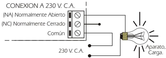
**CONSIDERACIONES SOBRE LA SALIDA.** Durante el funcionamiento del circuito, y según sea su carga, podrá producirse una fluctuación o un incorrecto funcionamiento de la salida. Si esto ocurre, instale un circuito antichispas entre los dos contactos del relé utilizados en la conexión, tal y como se muestra en el dibujo.
