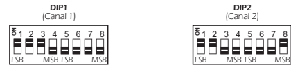
Fig. 6. Ejemplo de configuración del Canal 1 con el número 7, y del Canal 2 con el número 83.
