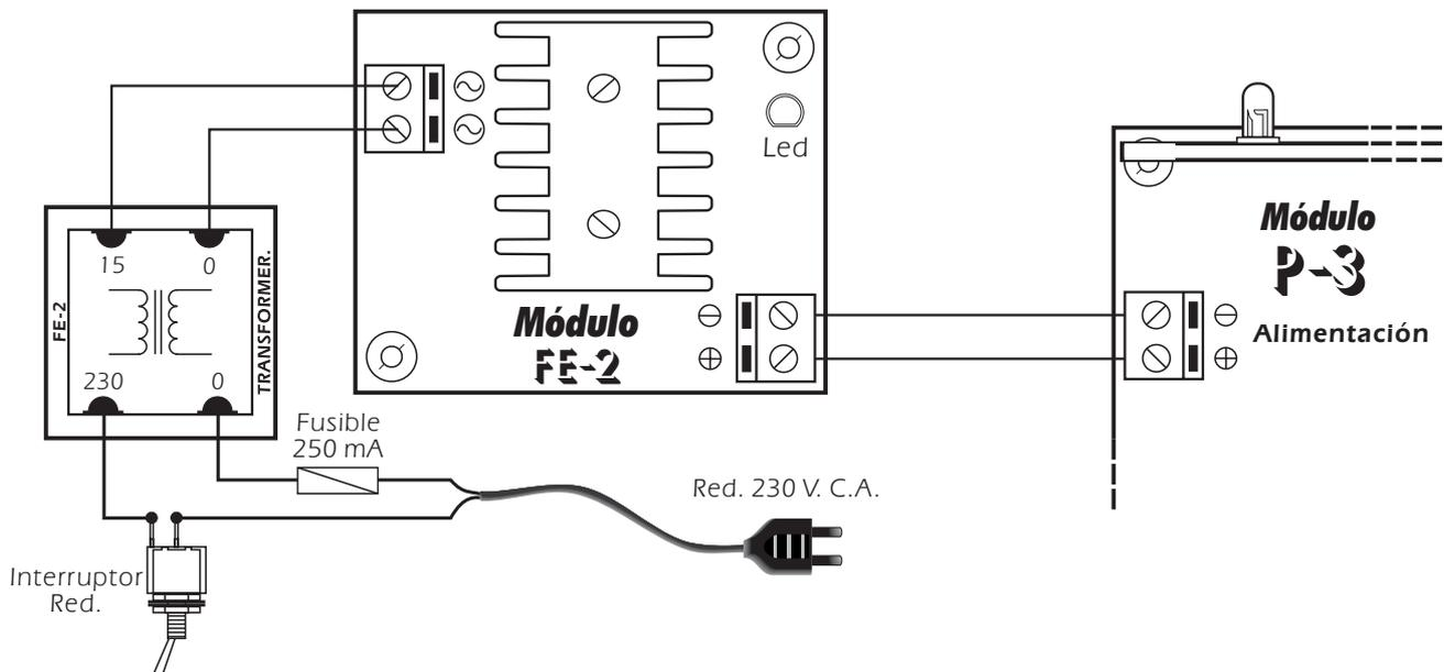
**FUNCIONAMIENTO.** Una vez haya realizado todas las conexiones del módulo active la alimentación. Automáticamente se iluminará uno de los cuatro leds que incorpora el circuito.
