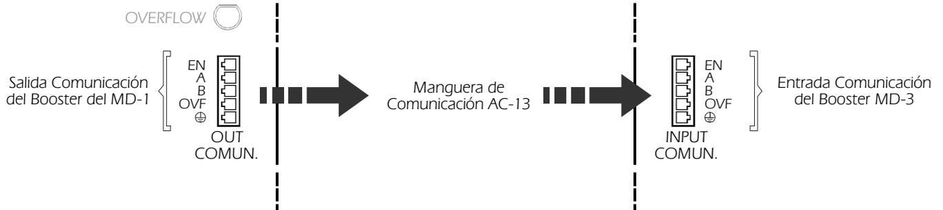
Fig. 6. Comunicación entre MD-1 y Booster esclavo MD-3.
