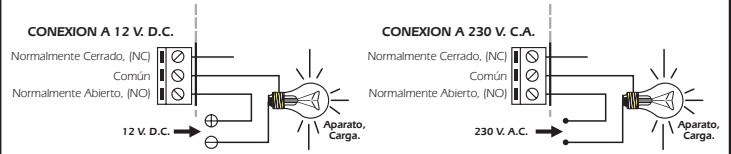
Fig. 3. Ejemplo de conexión a 12 V. D.C y a 230 V. C.A. de la salida del módulo.
