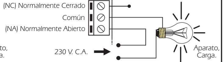
**CONSIDERACIONES SOBRE LA SALIDA.** Durante el funcionamiento del circuito, y según sea su carga, podrá producirse una fluctuación o un incorrecto funcionamiento de la salida.
