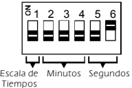
Fig. 2. Función de los Switchs.
