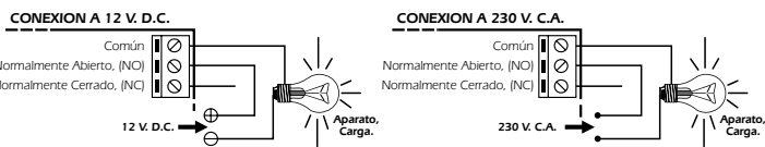
Fig. 1. Ejemplos de Conexión de la Carga.
