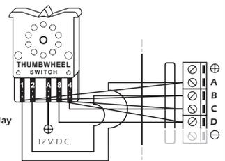
Pic. 1. Ejemplo de conexión del display con un Preselector BCD.
