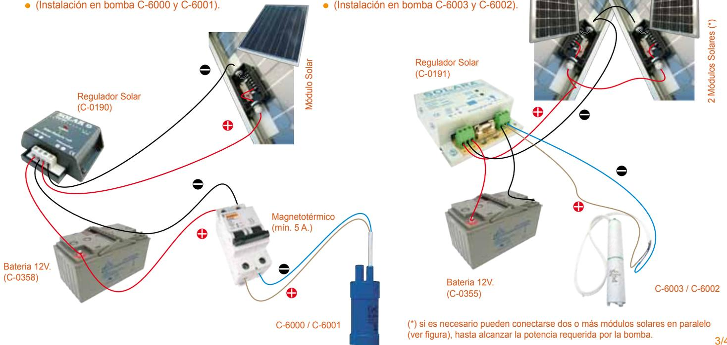
Fig. 5. Sistema solar automático para llenado de un depósito, con sensores de nivel máximo y mínimo.
