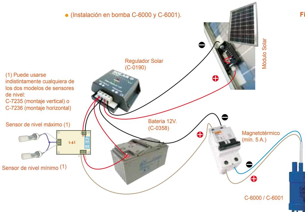
Fig. 6. Ejemplo de la instalación de los sensores.
